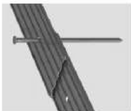
Połączenie na zakładkę, zabezpieczone gwoździem.
